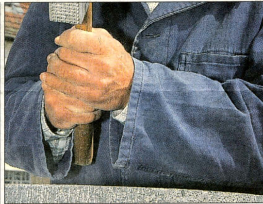
Die vom Sägen glatte Oberfläche muss mit einem Stockhammer wieder aufgeraut werden.
