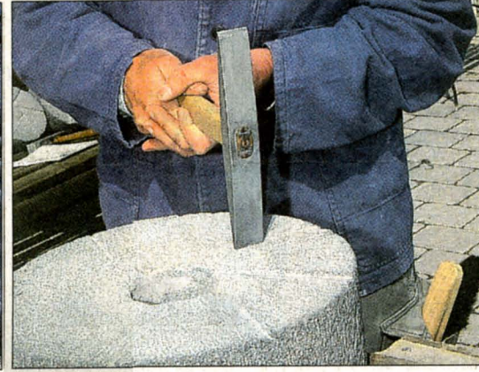
Die Furchen dienen dazu, den Stein luftdurchlässiger zu machen und das Korn zwischen die Steine zu treiben.
