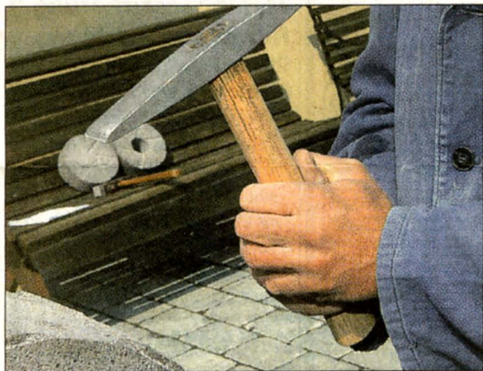
Der Stein wird im Steinbruch nur grob rund gesägt. Wolfgang Strakosch muss die Ecken mit der Bille noch abschlagen.
