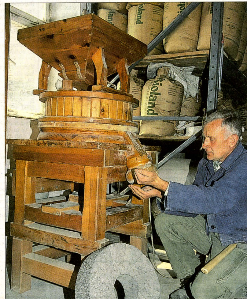
Die Naturmühlsteine werden zum Beispiel in einer Osttiroler Getreidemühle verwendet, hier zum Mahlen von Dinkelmehl.
